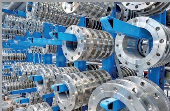
Les rayonnages à bras portants OHRA sont conçus et fabriqués individuellement pour toutes les marchandises du secteur de la métallurgie. Solution optimale pour le stockage de petites pièces ou les barres et tubes de même pour les couronnes et bobines en acier.
